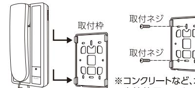
※コンクリートなど、木ネジが直接使用できない場所はスリーブを使用します。
