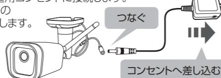
液晶モニターとの接続ができるればカメラのリンク(接続)ランプが点灯(緑色)します。
