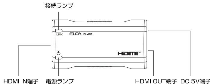
※接続するHDMIケーブルが1080pなどの高解像度に対応していない場合は、機器側の出力解像度を下げて使用してください。
