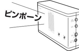
④受信器の音量ボタンを押します。→音量ボタンを押すごとに音色が次々に切り替わりますので、お好みの音色を選択してください。最後に鳴らした音色が報知音として設定されます。
