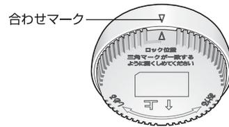
⑤ストッパーが【はずす】の位置にあることを確認し、防水押ボタン本体を上部から先に取付ホルダーにセットします。
