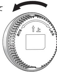
③単四形アルカリ乾電池2本を電池の極性を確認してセットします。
