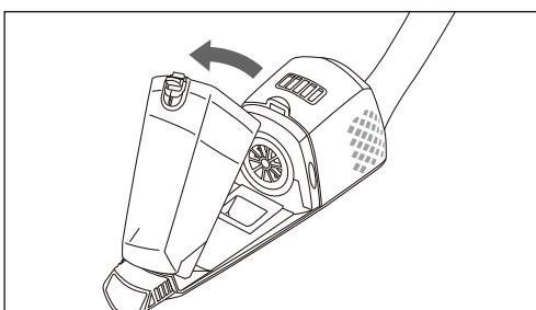
ハンディユニットを取り外し、ダストカップ取り外しボタンを押し下げたまま、ダストカップの両側面を手で持ち、前に倒して取り外してください。
