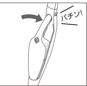
ハンディユニットのハンドルを本体側に押して取付けます。パチンという装着音がして、ハンディユニットが本体から外れないことを確認してください。
