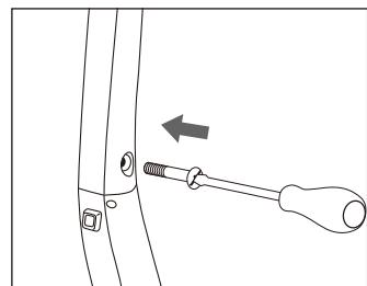
ハンドル部を本体に差し込み、ドライバーでネジを締めます。
