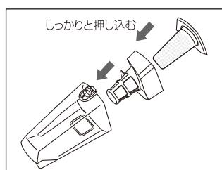
マイクロフィルターとフィルターをしっかりと押し込み、元の位置に取り付けてください。ダストカップをハンディユニットに取り付けてください。
