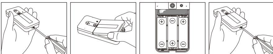
① プラスドライバーで電池カバー下部のネジを外します。(ネジをなくさないようご注意ください。)
