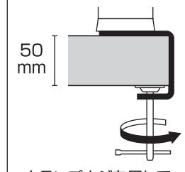
クランプねじを回して机などに取り付けます。
