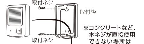
※コンクリートなど、木ネジが直接使用できない場所はスリーブを使用します。
