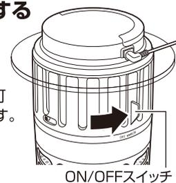
本体のON/OFFスイッチをOFF側にスライドさせるとUV冷陰極管が消灯し、ファンが止まります。
