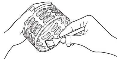
※汚れがひどい時は捕獲ケースを水洗いしてください。水洗い後は水気をとり、十分に乾燥させてから本体に取り付けてください。
