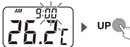
③もう一度「SETボタン」を押すと時間の部分が点滅し、 時間の設定になります。「UPボタン」を押すたびに 1時間ずつ進みます。「UPボタン」を長押しすると 速く進みます。
