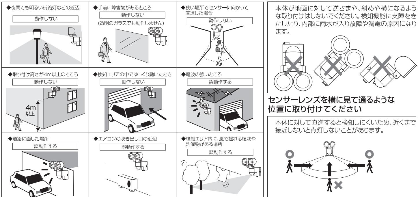
本体が地面に対して逆さまや、斜めや横になるような取り付けはしないでください。検知機能に支障をきたしたり、内部に雨水が入り故障や漏電の原因になります。
