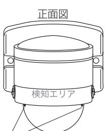
レンズ範囲の印を正面(『検知エリア』の刻印部分)に合わせてください
