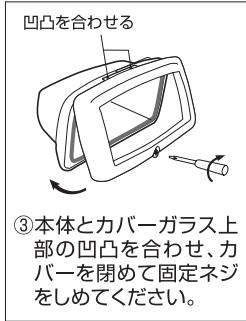
③本体とカバーガラス上部の凹凸を合わせ、カバーを閉めて固定ネジをしめてください。
