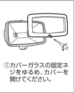
①カバーガラスの固定ネジをゆるめ、カバーを開けてください。
