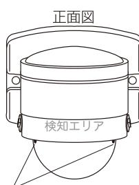
レンズ範囲の印を正面(「検知エリア」の刻印部分)に合わせてください。
