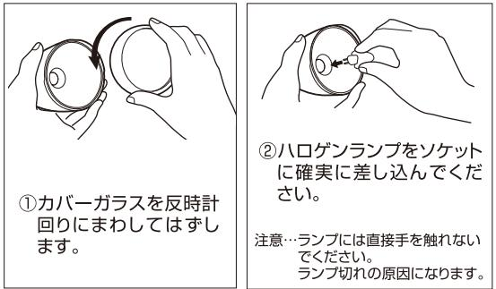
**!** ランプ取付け、またはランプ交換の際は、必ず電源プラグを電源（コンセント）から抜いてください。
