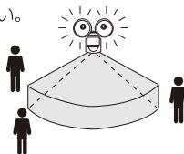
② 消灯後検知エリアを横切るように歩き、ランプを点灯させて最適な検知エリアになるようにセンサー部の角度調整を行います。
