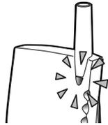
⑤センサーライト(送信側)のセンサーを検知させ、電波信号を送信させます。
