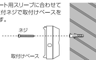
③図のように本体の凹部を取付けベースの凸部分に合わせて固定します。
