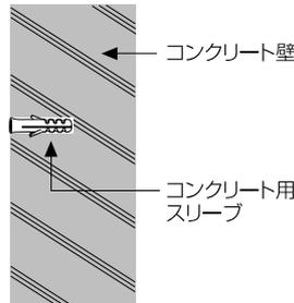
②コンクリート用スリーブに合わせて付属の取付ネジで取付けベースを固定します。
