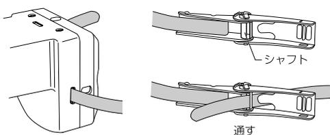
①本体のステンレスバンド通し穴(上下または左右の2箇所)にステンレスバンドを通します。
