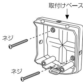
②図のように本体の凹部を取付けベースの凸部分に合わせて固定します。
