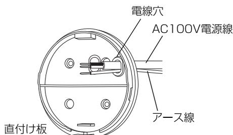
⑥AC100V電源線およびアース線の被ふくをむき、端子台に結線してください。
