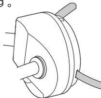
③バンドを取付箇所(ポールなど)に巻付け、先端をシャフトの間(シャフトは2枚構成)に通して、バンドにたるみのない程度に張ります。
