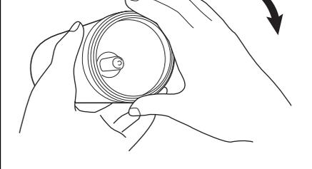
**⚠** ランプ取り付け、またはランプ交換の際は、必ず電源プラグを電源(コンセント)から抜いてください。
