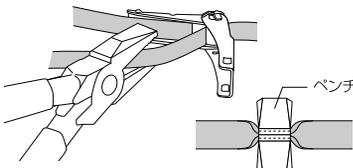
※図のようにペンチでバンドを2つ折りにし左右に振ると、切断しやすくなります。
