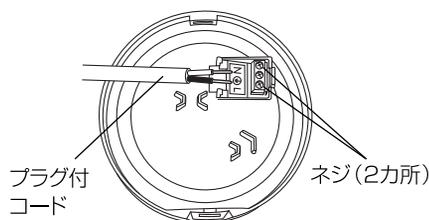
⑤直付け板の電線穴にAC100V電源線とアース線を通してください。
