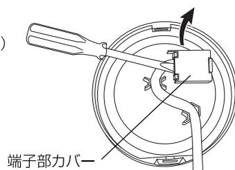
④端子台のネジ(2ヶ所)をゆるめ、プラグ付コードを取り外します。
