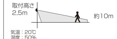
※センサーは検知エリア内の温度変化を検知するため、人以外の熱源(動物・車など)も検知します。
