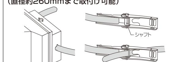
①取付けベースのステンレスバンド通し穴(上下または左右の2箇所)にステンレスバンドを通しておきます。
