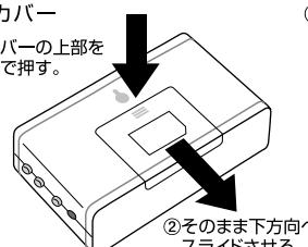
②単三形アルカリ乾電池3本を電池の極性を確認してセットし、電池カバーを元通りに閉じます。
