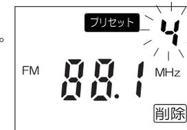
③モードボタンを押すと、放送局がプリセットから削除され、プリセット番号が消えます。削除をキャンセルする場合は、モードボタン以外のボタンを押します。
