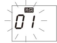
D ④運転切換ボタンを押し、設定したいメーカーの運転モード（自動、冷房、暖房、除湿のいずれか）に切り替えます。
