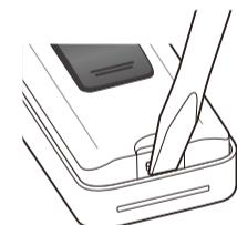
②押ボタン本体下部の溝から電池カバーをはずします。
