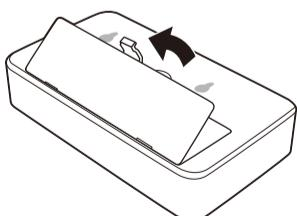
②単三形アルカリ乾電池3本を電池の極性を確認してセットし、電池カバーを元通りに閉じます。
