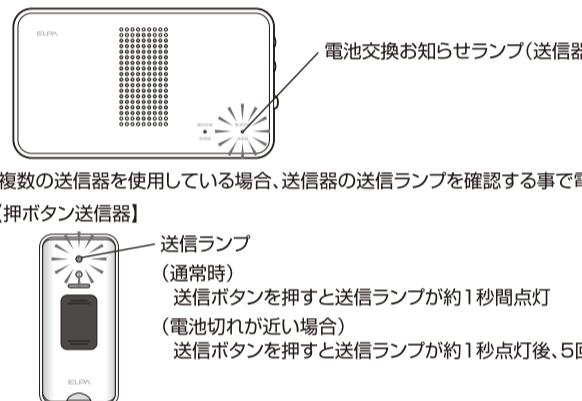
・複数の送信器を使用している場合、送信器の送信ランプを確認する事で電池交換が必要な送信器がわかります。
